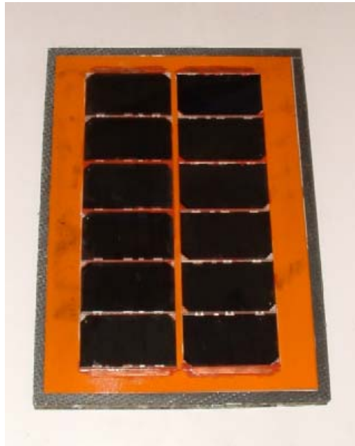
Figura 4: pannello solare di prova realizzato per testare le proprietà elettriche delle celle e le proprietà meccaniche dell'incollaggio.
