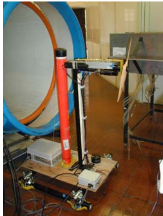
Figure 2: (sin) il primo sottosistema. Nel cilindro rosso la trave d'acciaio la cui flessione forniva i dati dei test
