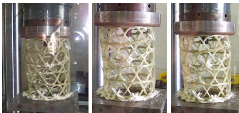
fig. 16 sequenza di deformazione del prototipo n° 1
