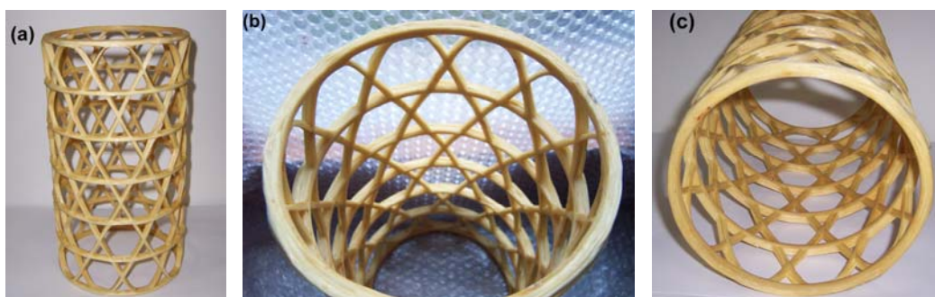
fig. 13 prototipo cilindrico anisogrid in fibra di vetro pre – preg
