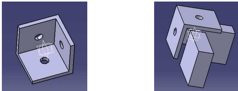
Figura 2: Schema CAD di un sistema di giunzione, singolo e con i pannelli
