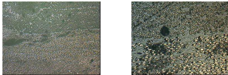
Figura 13: a sx interfaccia braided-unidirezionale (50x), a dx interfaccia braided-unidirezionale (200x)
