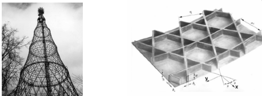
Figura 5 : Radio Tower di Mosca e spaccato di una struttura lattice anisogrid a simmetria cilindrica
