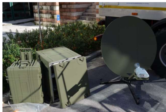
Figura 31 – Terminale Trolley Ka per Emerge
