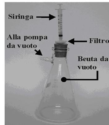
fig. 4.5 sistema di filtraggio mediante una beuta da vuoto
