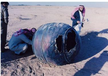
Figura 16: serbatoio di satellite rientrato in atmosfera e caduto al suolo
